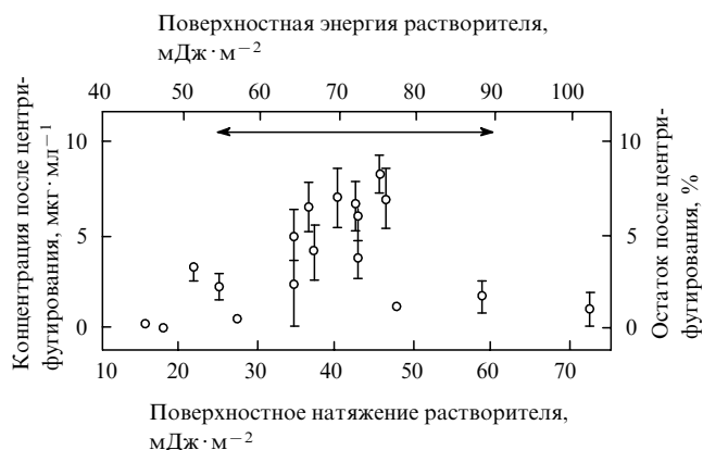
Рис. 4. Концентрации графеновых дисперсий, полученных из графита, после центрифугирования для ряда растворителей с различными значениями поверхностного натяжения. 67 Концентрация до центрифугирования 0.1 мг·мл -1 . Горизонтальная стрелка показывает приблизительный диапазон значений поверхностных энергий графита.
